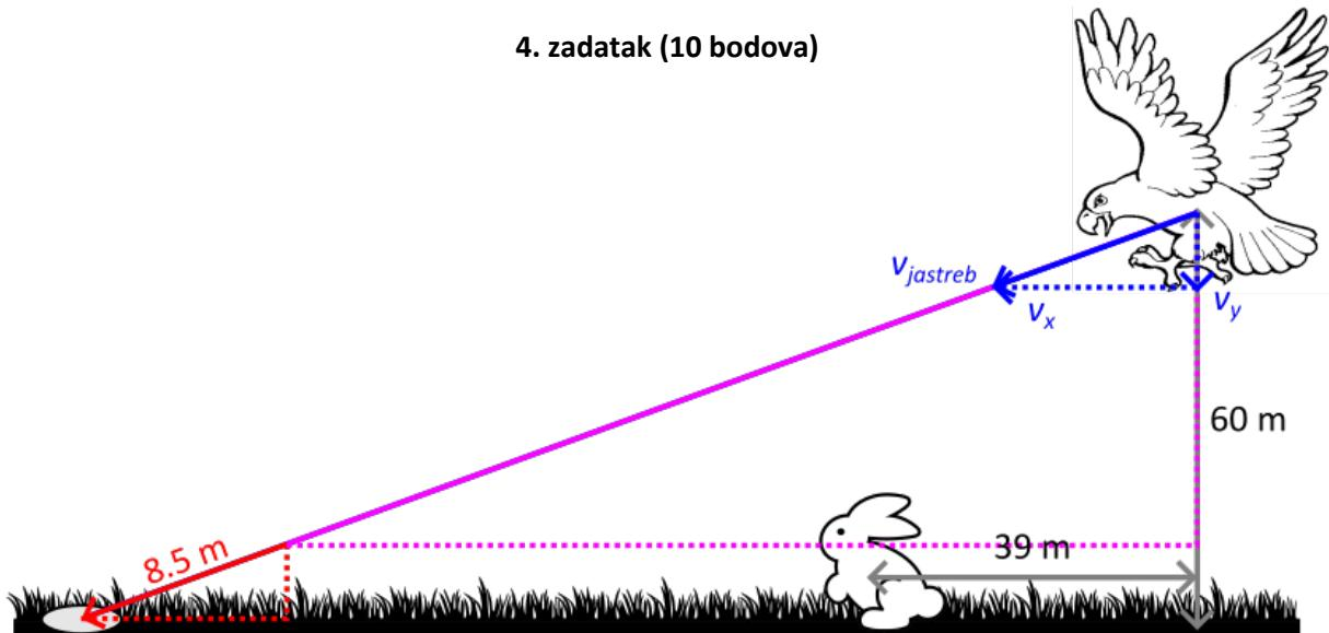
Brzinu jastreba  $v_{jastreb}$  rastavimo na horizontalnu komponentu  $v_x$  (prema lijevo) i vertikalnu komponentu  $v_y$  (prema dolje). Sa slike možemo zaključiti da za vrijeme gibanja zeca jastreb prelazi horizontalnu, odnosno vertikalnu udaljenost:
