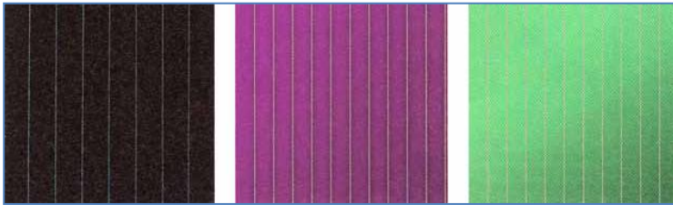
Slika 3.6. CIS solarna ćelija, amorfn silicijeva ćelija, solarna ćelija od kadmijeva telurida
