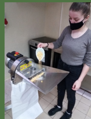
Suhe biljke kao i zrnate plodove meljemo u malom mlinu čekičaru.
