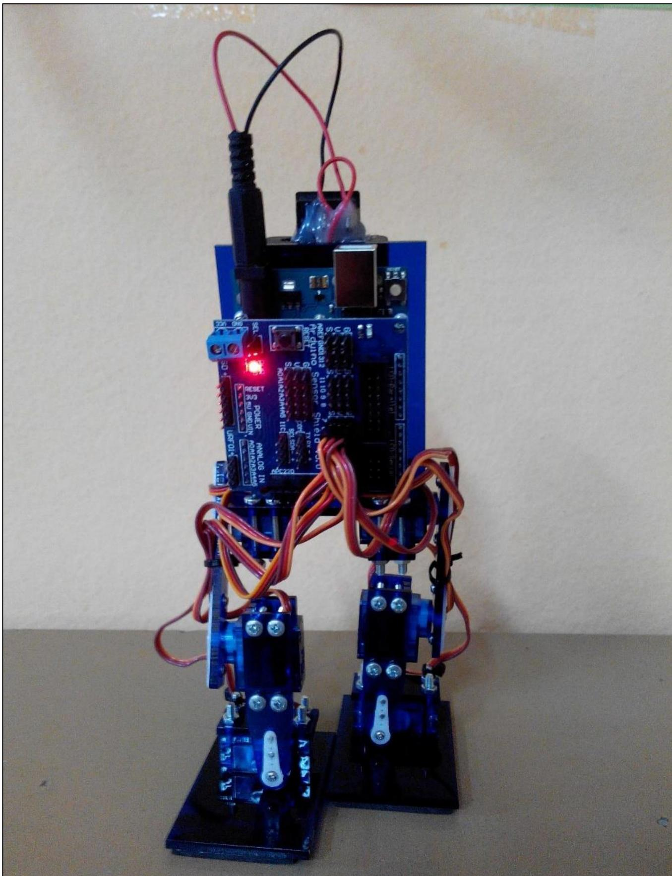
**Biped (dvonožna životinja) 6-servo robot** je hodajući robot koji oponaša hod čovjeka. Kretanje mu omogućuje 6 servo motora koji predstavljaju zglobove nogu. Ovo je vrlo zahtjevan projekt i s mehaničke i s programske strane.
