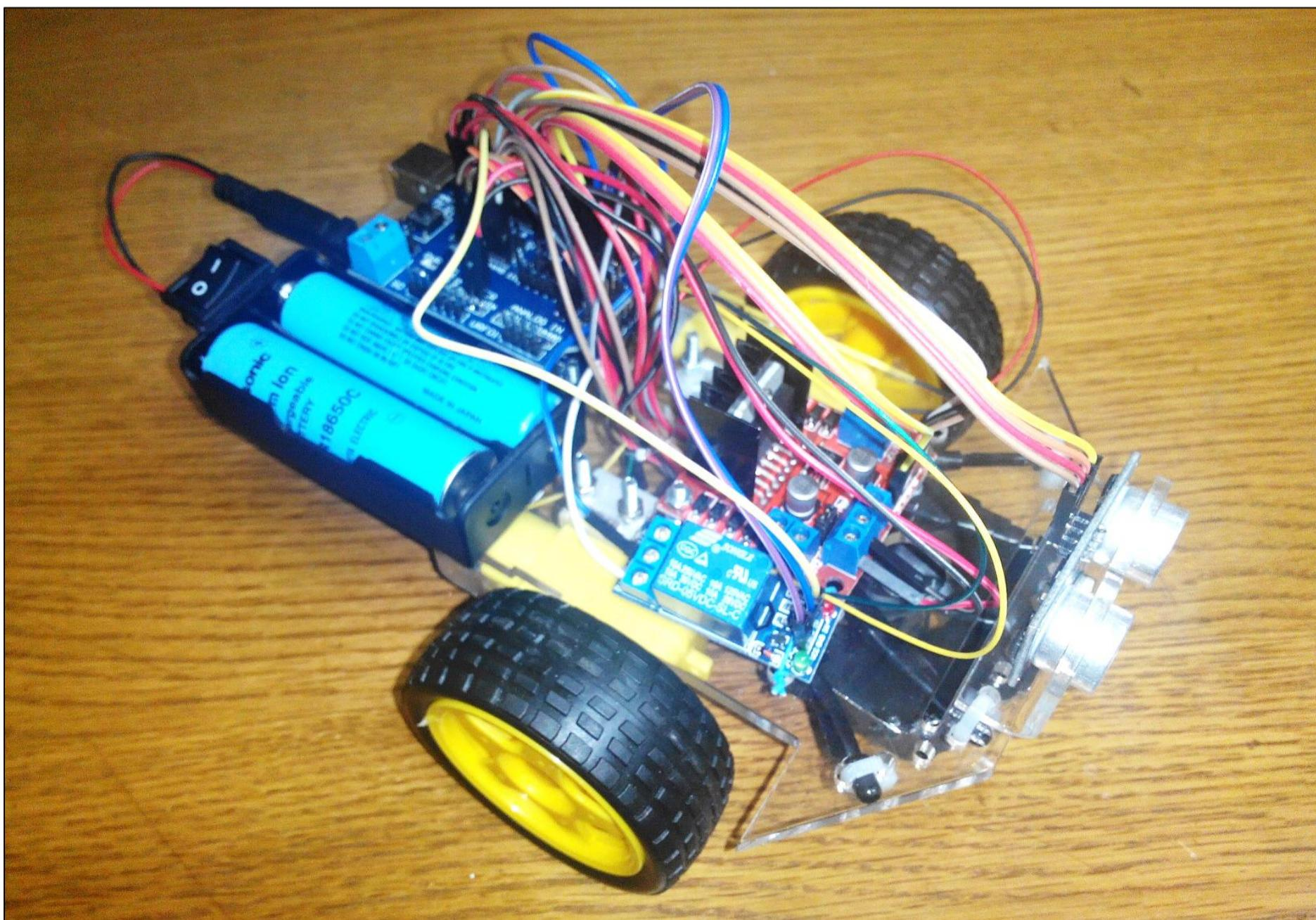
Za izradu korišteno: Arduino Uno R3, dc motori, L298N motor driver, senzori vatre, ultrazvučni senzor, spojne žice, konstrukcija, ventilator, 18650 baterije, kućište za baterije
