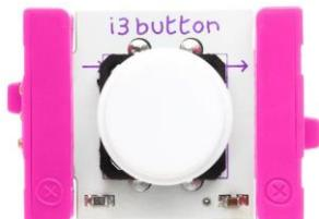
Ovaj ulazni modul sadrži jedno tipkalo. Kada je tipkalo pritisnuto signal prolazi kroz modul i može dalje do sljedećeg modula u spoju, a kada je tipkalo otpušteno ne propušta signal.
