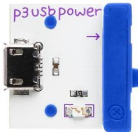
Ovaj modul koristi se u svakom littleBits projektu jer služi za napajanje spoja. U spoju ga se postavlja na početku te se na njega spajaju ostali moduli. USB kablom povežite modul za napajanje priključivanjem na računalo ili na USB adapter izravno u utičnicu.
