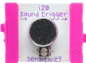
Ovaj ulazni modul detektira zvuk – kada je zvuk jači od postavljenog praga daje signal na izlazu, inače ne propušta signal. Odvijačem iz kompleta namješta se razina glasnoće zvuka na kojoj modul reagira propuštanjem signala dalje u spoj.
