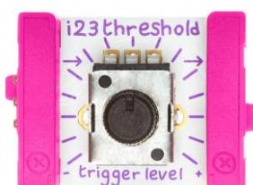
Ovaj posebni modul uspoređuje ulazni signal s naponom koji ste postavili okretnim gumbom. Ako je ulazni napon veći od odabranog napona, threshold podesi izlazni napon na 5 volta, a ako je manji ne propušta ga. Ovaj modul omogućava svim senzorima da postanu „triger“ moduli.
