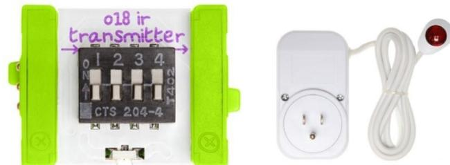
IR transmitter je odašiljač infracrvenog svijetla kojeg prima IR prijemnik spojen na AC prekidač. Odašiljačem se može aktivirati prekidač na koji je priključen neki aparat (primjerice svjetiljka) koji se može paliti i gasiti korištenjem ovog modula.
