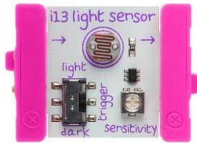
Svjetlosni senzor jedan je od ulaznih LittleBits modula. On mjeri količinu svjetlosti koja na njega upada i proporcionalno tome daje izlazni signal. Ima dva načina rada: light i dark. Kad ga se postavi u način-- rada light, što više svjetla senzor primi, to veći signal koji šalje izlaznom modulu. U dark načinu rada, događa se upravo suprotno – izlazni signal se povećava dok se svjetlo smanjuje.
