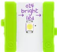
Kad ovaj modul primi signal, svjetli bijelom bojom. Ovisno o jačini signala, može svjetliti jače ili slabije.
