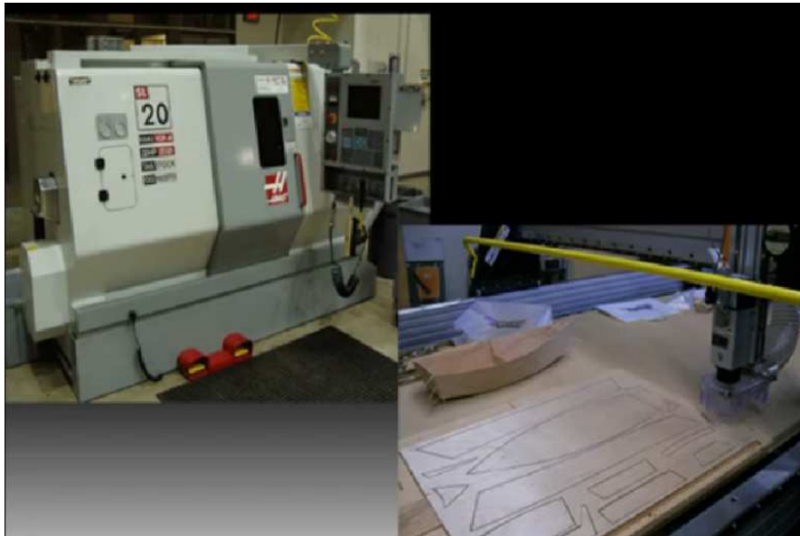
Cnc stroj i rezanje više obradaka (gniježđenje)
