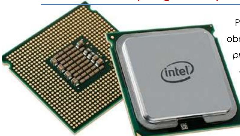
Procesor ili središnja jedinica za obradu podataka (eng. *central processing unit*) se sastoji od dva dijela, od: a) upravljačke jedinice koja nadgleda i upravlja pojedinim dijelovima računala te računalom kao cjelinom.
