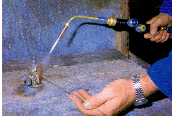
Slika 1. Postupak plinskog zavarivanja
