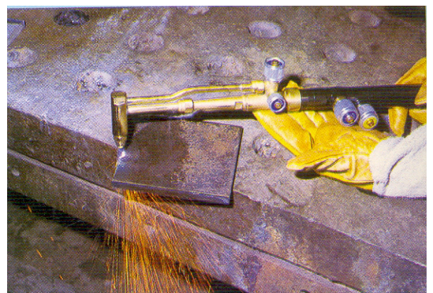
Slika 25. Postupak plinskog rezanja
